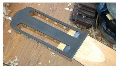
La languette est réalisée sous la fraiseuse, avec la tête placée sur un gabarit où elle est guidée en rotation. L'angle de  $14^\circ$ , où le bas de la tête vient buter contre le manche, est réalisé au ciseau, guidé par un bloc du bon angle.
