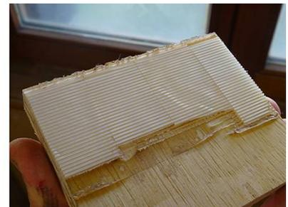
**Les filets** sont collés dans un moule dédié en plexiglas, simplement doté d'une rainure de 1,5mm de profondeur (l'épaisseur de notre rosace) et de 6,3 mm de large (soit  $9 \times 0,7$ , la largeur de nos 9 filets). J'ai abandonné l'idée de réussir à produire en série des chevrons de la taille permettant de s'ajuster parfaitement : l'ajustage individuel des chevrons est nécessaire.
