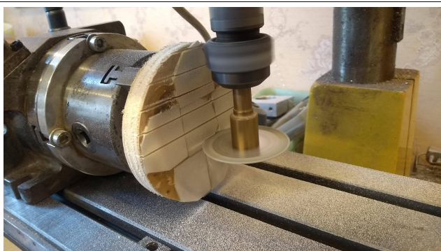
Une troisième passe pour diviser les losanges en triangles
