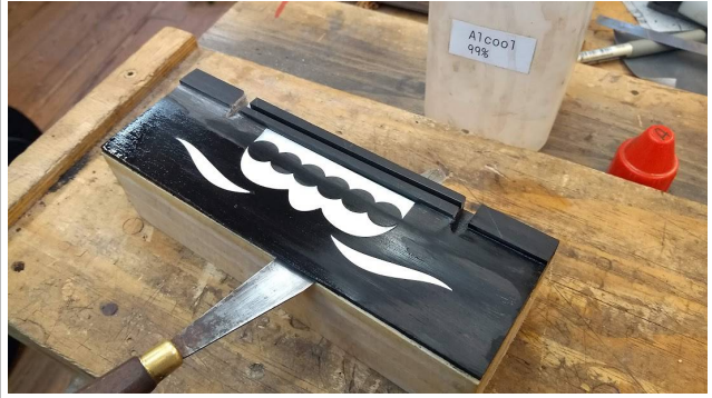
Décollage du support, nettoyage du double-face
