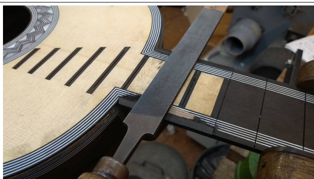
Mise à niveau à la lime
