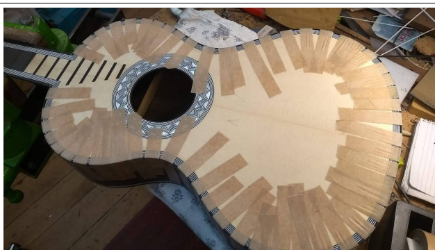
Pose du filet de bord
