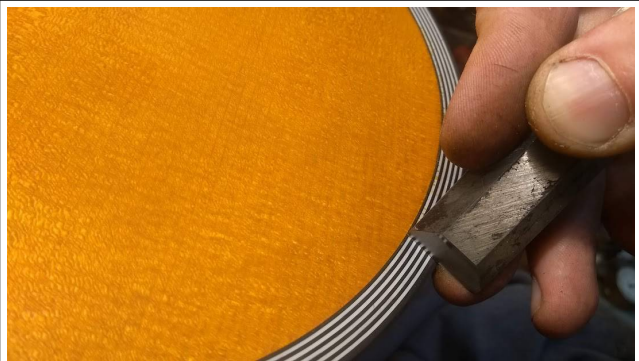
Nettoyage des bavures de teinte sur les filets au ciseau
