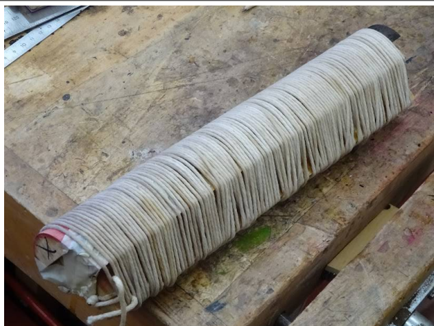
Collage du placage sur le manche, bien ficelé
