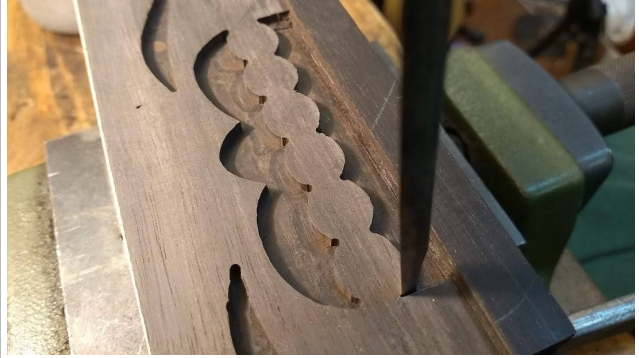
On dégage les angles aigus au burin et au cutter
