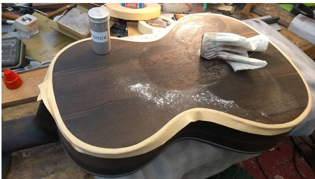
Pouche-porage du palissandre à la ponce
