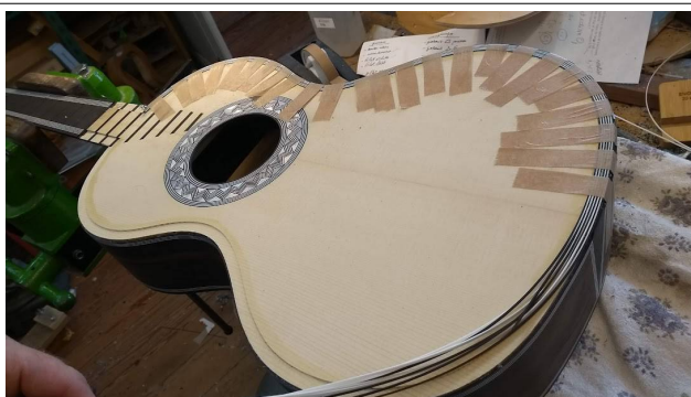
Pose de la fileterie de table, 11 filets en une fois
