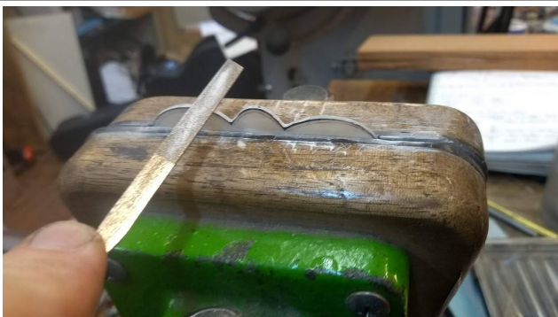
On rectifie à la lime diamantée
