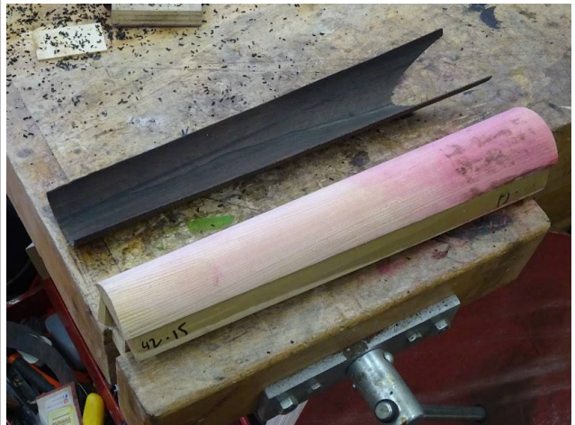
On démoule, prêt à coller
