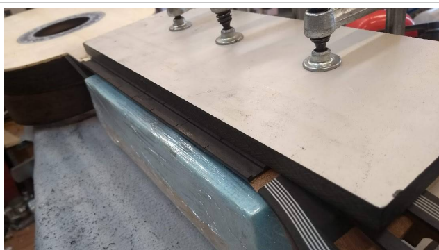
Fraisage de la défonce de filets sur la touche
