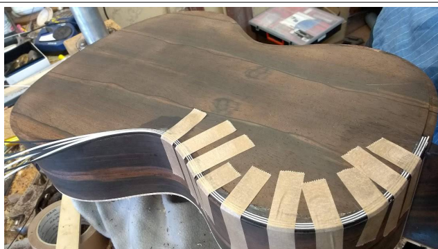
Pose de la fileterie de dos, 7 brins en une fois
