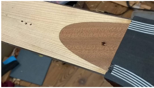
Languette de la tête arasée au ciseau
