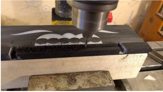
Défonce de la rainure de sillet
