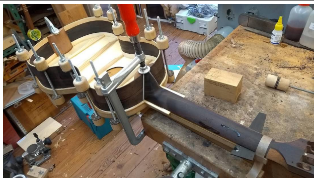
Pose de la table sur les éclisses
