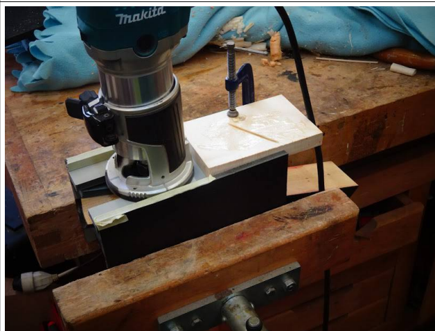
Réalisation de la défonce du joint de tête
