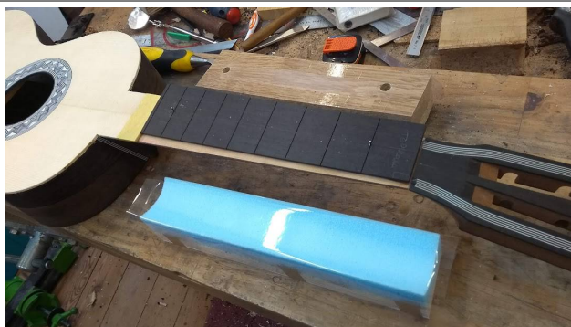
Pose de la touche, maintenue par 2 clous
