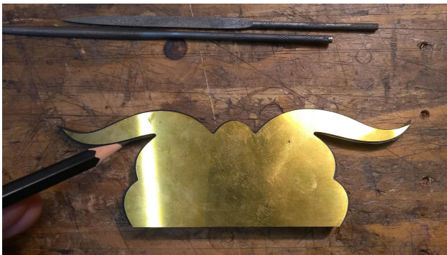
Approche du contour à la lime, à l'aide du gabarit laiton
