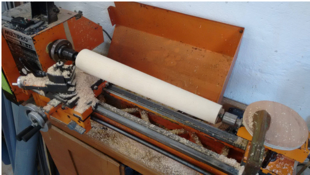
Réalisation d'une forme à cintrer au tour
