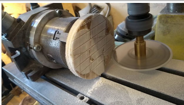
Deuxième passe à 110° (triangles extérieurs) ou 96,7° (triangles intérieurs)
