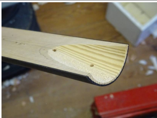
Joint prêt à recevoir la tête
