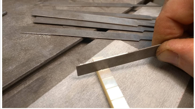
Ebauche aux limes calibrées
